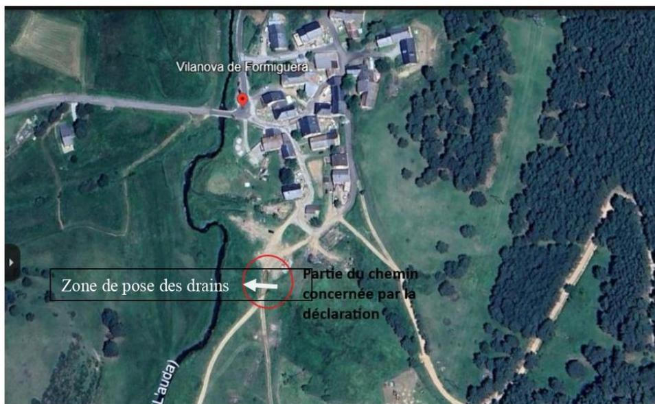
Nous souhaitons poser des drains et remblayer le trou formé dans le temps avec des graviers pour permettre à l'eau de s'écouler et éviter l'érosion e cette piste régulièrement empruntée par des 4x4 et occasionnellement par des tracteurs.
