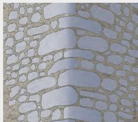
Système constructif d'une chaîne angle (harpée*) en moellon
