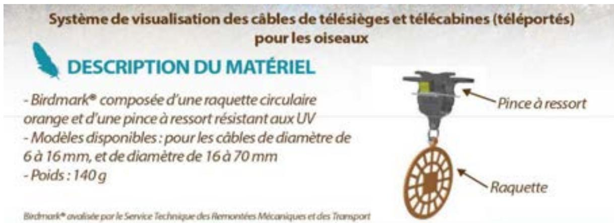
L'espacement préconisé entre 2 pièces est de 5 à 7 mètres. Etant donné une mesure préventive d'équipement de câble de télésiège à faible risque de collision, 1 dispositif tous les 12 m est justifiable.
